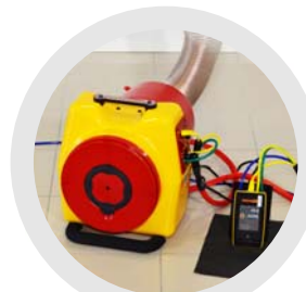
Contrôle des gaines de ventilation
