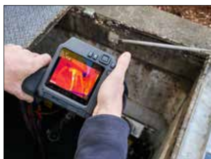
Le bloc optique rotatif à 180° et l'écran 4" lumineux rendent la série FLIR T500 facile à utiliser dans n'importe quel environnement
