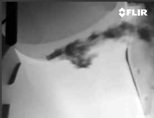
DÉTECTEZ LES FUITES DU COMPRESSEUR R-124
