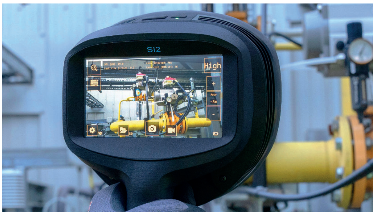
Caméra acoustique pour la détection de fuites FLIR Si2 sur le terrain calculant la taille et le coût de la fuite.
