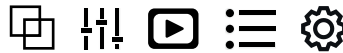
Figure 6.1 Icônes du menu principal (de gauche à droite : mode Image, Paramètres thermiques, Galerie, Menu avancé, Paramètres)
