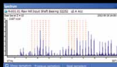
Symptôme d'engrènement sur spectre vibratoire
