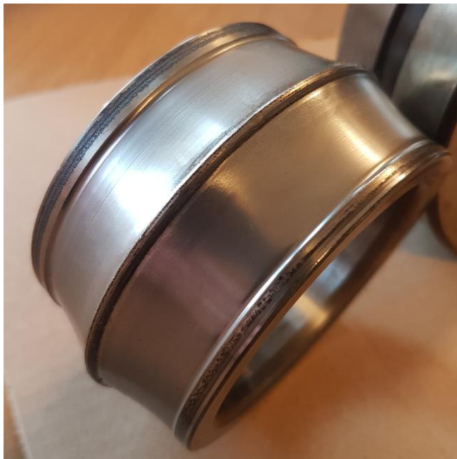
Img. 1 Roulement endommagé provenant du premier arbre intermédiaire.
