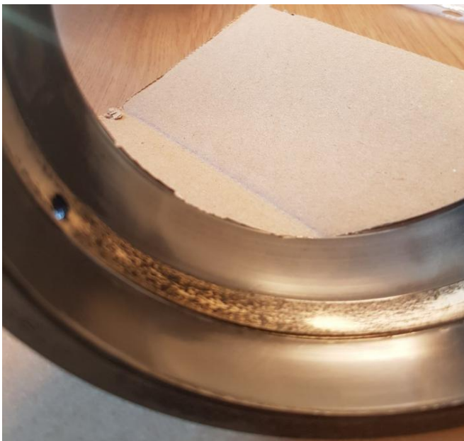
Img. 2 Roulement endommagé provenant du premier arbre intermédiaire.
