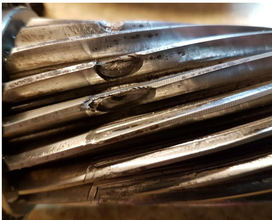
Img. 6 Engrenage de l'arbre d'entrée endommagé.
