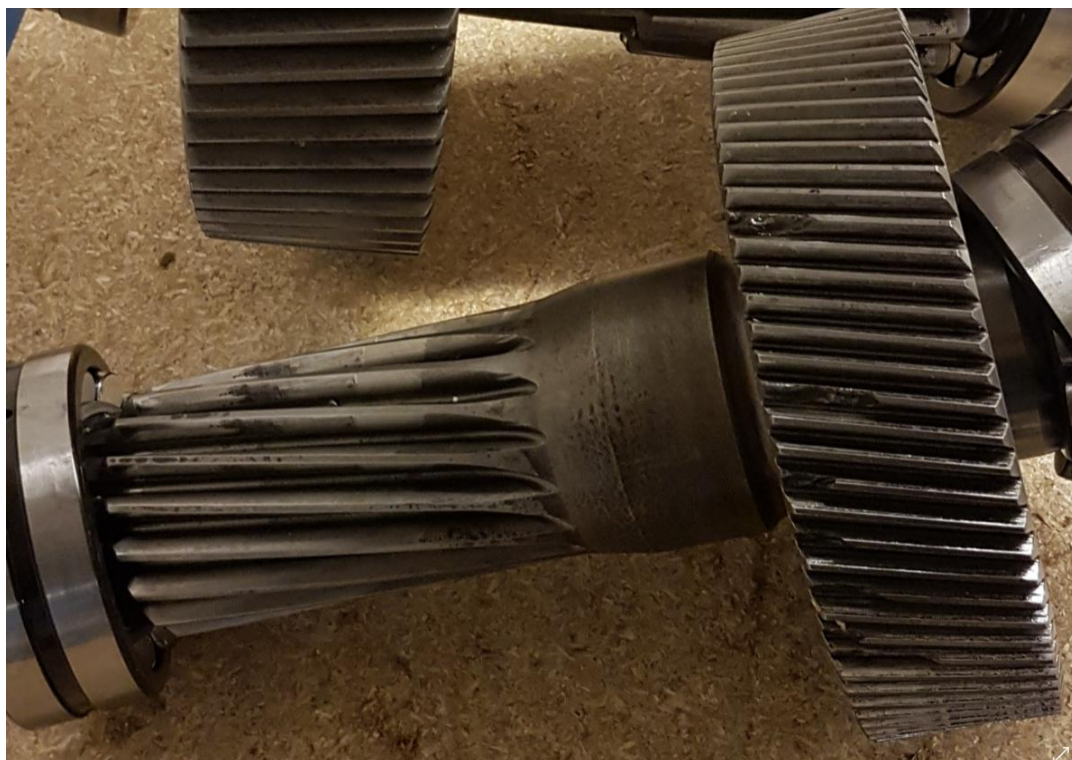
Img 4. Arbre intermédiaire n°1 endommagé.
