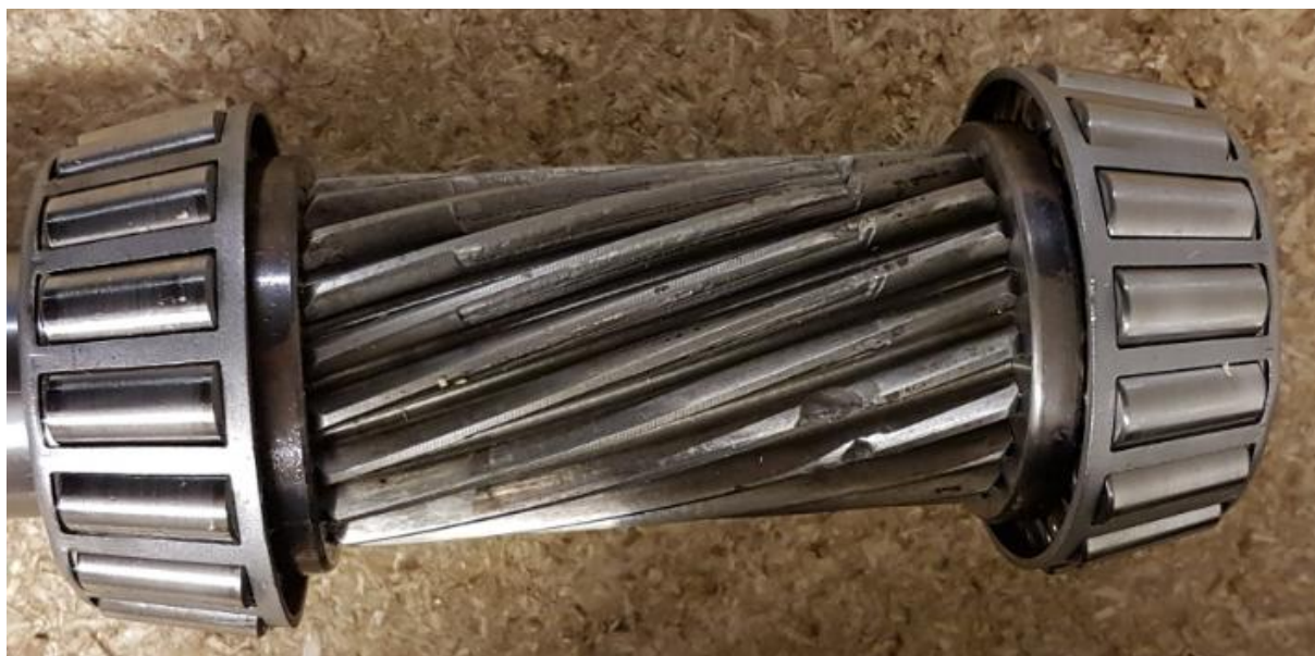
Img. 5 Engrenage de l'arbre d'entrée endommagé.
