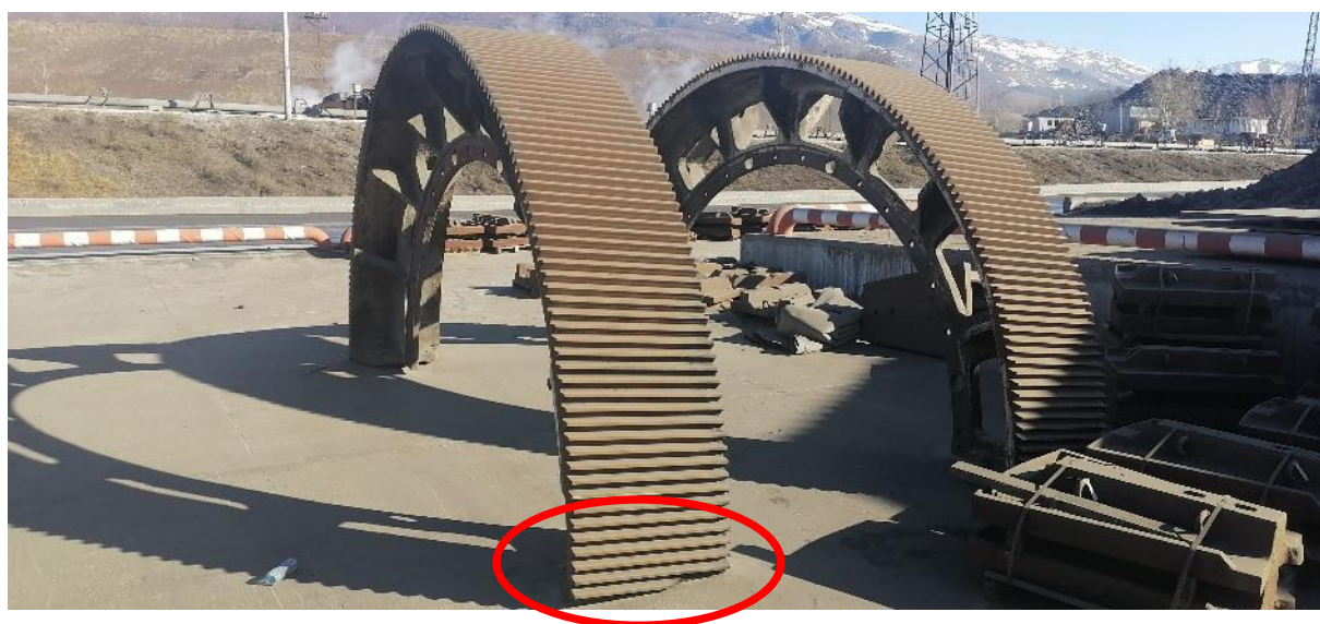
Image 15 La piste extérieure avec la dent endommagée.
