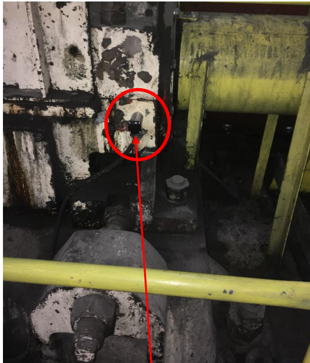
Capteur de vibration sans fil AIRIUS à communication WIFI
