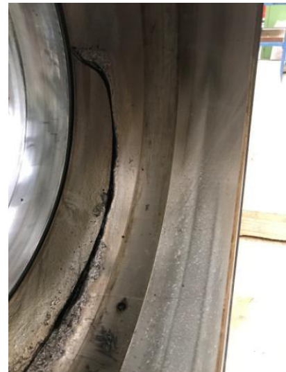
Image 4. Photos montrant des dommages sévères – niveau 4 – sur la bague intérieure et la bague extérieure du roulement.
