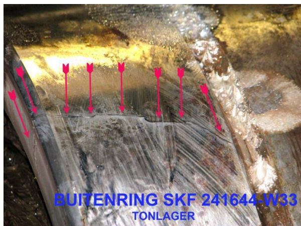
Image 2. Photos du roulement 3B montrant les dommages. Le roulement a été remplacé début janvier 2014
