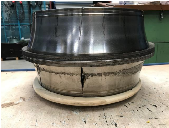
Image 4. Photos montrant des dommages sévères – niveau 4 – sur la bague intérieure et la bague extérieure du roulement.
